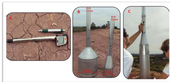
Figura 3 – (A) Termo-anemômetro digital portátil TESTO modelo 405-V1; (B) Adaptadores confeccionados no diâmetro dos drenos; (C) Medição da velocidade do biogás no dreno.
